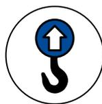
Punto de levantamiento. Instale los accesorios de levantamiento en esta ubicación y solo en las ubicaciones identificadas como tal. No conecte el dispositivo de levantamiento directamente en el punto de levantamiento.
