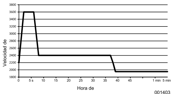
Figura 3-9. Velocidades de funcionamiento típicas
